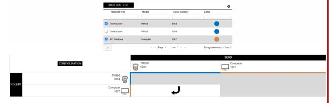
Pour l'exemple ci-dessous, nous avons 2 Chronomètres, 1 pour le départ et 1 pour l'arrivée, afin de permettre la transmission des temps entre le départ et l'arrivée et également un PC Interface afin de réceptionner toutes les trames sur un logiciel de chronométrage (via GSM Interface).
